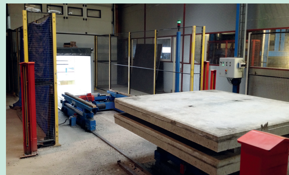
Bij Struyk Verwo worden zware betonplaten in de laatste fase van de productie handmatig bewerkt.
